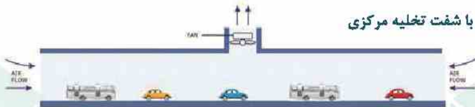
۵- تهویه طولی با شفت های تامین و تخلیه هوای مرکزی
