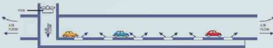
۸- سیستم تامین هوای نیمه عرضی
